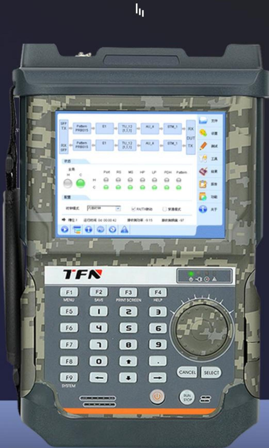
Support DSN/PDH testing function for DS1/DS3, E1/E3/E4 interfaces
